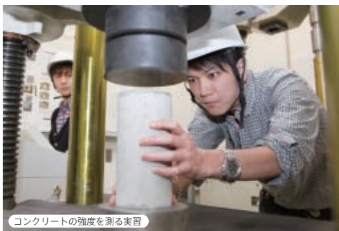
コンクリートの強度を測る実習
