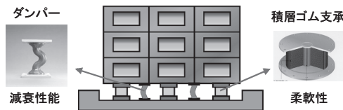
図-1 免震・制振構造の概念図
