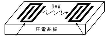
SAW 励振電極 (すだれ状電極) 受信電極 (基板サイズは数 mm ~ 数十 mm 四方)
